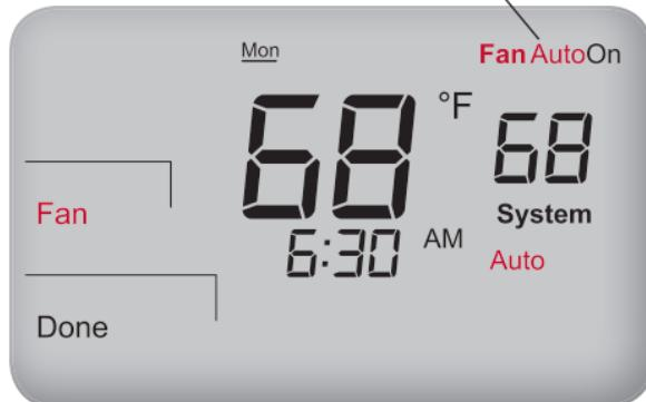
1. Oprima Fan (ventilador) para configurar el funcionamiento del ventilador.
